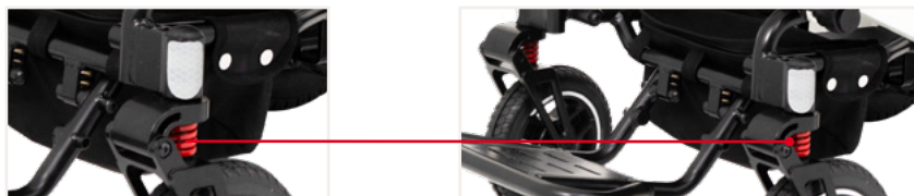
Abbildung 4: Die Federung an der Vorderradgabel des ergoflix
