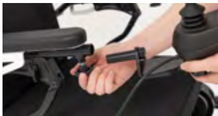
Abbildung 2: Entfernen des Bedienmoduls
