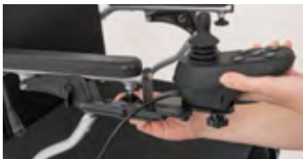
Figure 11: Mise en place du module de commande
