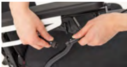
Abbildung 1: Trennen des Kabels
