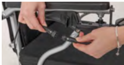
Figure 12: Connexion du câble
