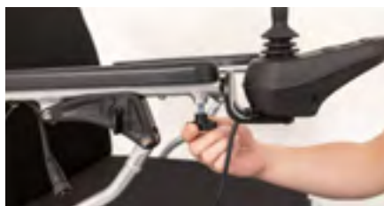
Figure 2: Desserrage la vis de blocage
