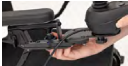
Abbildung 12: Einsetzen des Bedienmoduls
