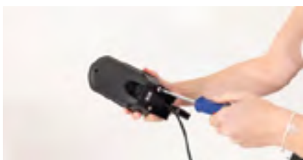
Figure 3: Desserrage des vis
