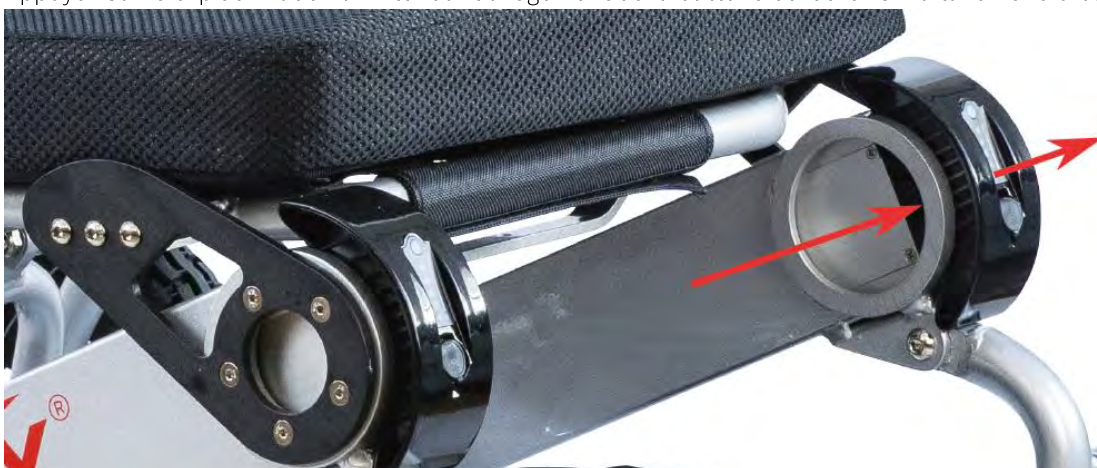
Illustration 7 : remplacement de la batterie
