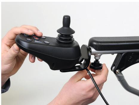
Abbildung 2: Lösen des Bedienmoduls von der Armlehne
