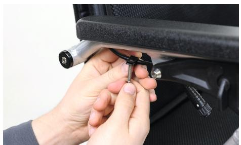
Abbildung 7: Lösen der Schraube von dem Bedienmodulkabel
