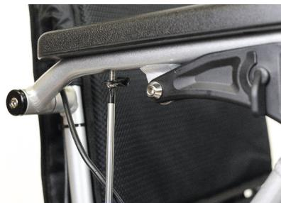
Abbildung 8: Fixieren der Armlehne mit Schraube und Lasche
