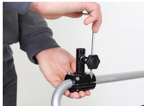
Figure 12 : Serrage léger des vis
