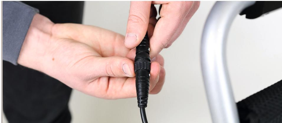
Abbildung 16: Verbinden des Bedienmodulkabels mit dem Anschlusskabel
