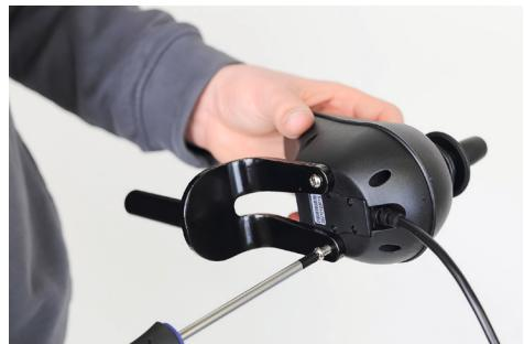
Illustration 5 : Vissage du module de commande sur la fourche
