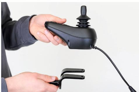
Abbildung 4: Positionierung der Gabel und des Bedienmoduls
