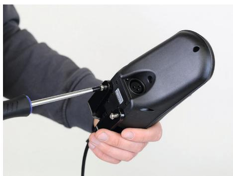
Figure 3 : Détachement du module de commande de la fourche
