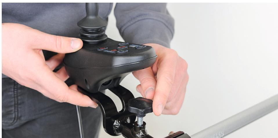
Figure 15 : Fixation du module de commande sur l'adaptateur
