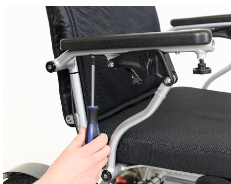
Abbildung 6: Lösen des Bedienmodulkabels von der Armlehne
