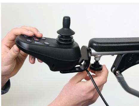
Figure 2 : Détachement du module de commande de l'accoudoir
