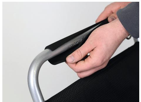
Abbildung 10: Entfernen des Schaumstoffs
