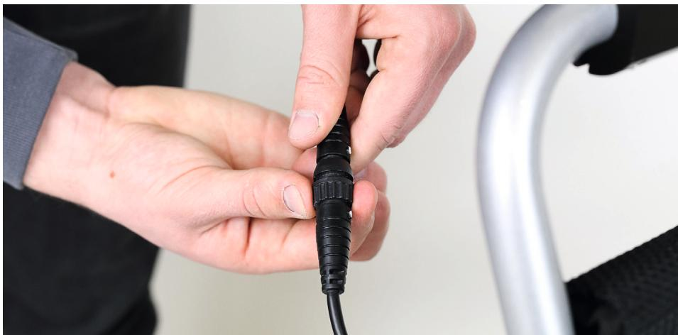
Figure 16 : Connexion du câble du module de commande au câble de raccordement du fauteuil
