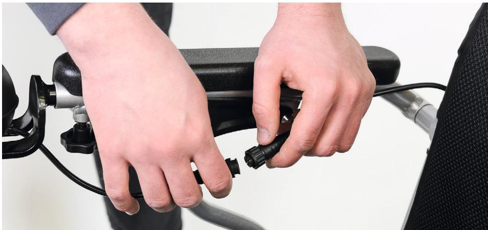
Figure 1 : Déconnexion du câble du module de commande du raccordement du fauteuil roulant
