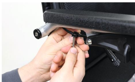
Figure 7 : Desserrage de la vis du câble du module de commande
