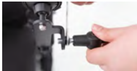
Abbildung 11: Ziehe die Mutter mithilfe des Maulschlüssels fest
