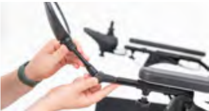
Abbildung 14: Lösen und Verstellen am Gelenk der Innensechskantschraube
