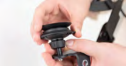
Figure 3 : Vissage du bouchon à vis par le bas
