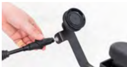
Figure 10 : Montage du rétroviseur sur le cadre métallique
