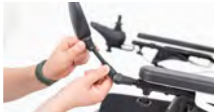
Figure 15 : Desserrage de l'écrou pour effectuer un positionnement individuel
