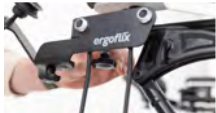
Abbildung 6: Universalhalter mit der Feststellschraube fixieren
