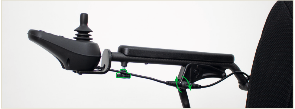
Abbildung 5: Das Bedienmodul fixieren und verbinden.
