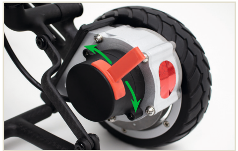
Abbildung 11: Aktivieren oder Deaktivieren der Feststellbremsen
