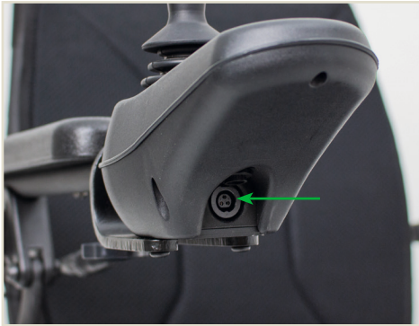
Abbildung 6: Die Anschlüsse für das Ladegerät
