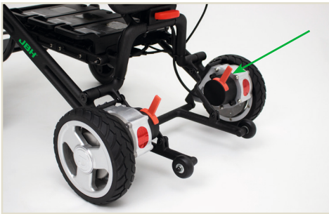
Abbildung 10: Position der Feststellbremsen
