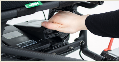
Abbildung 7: Den Akku wechseln
