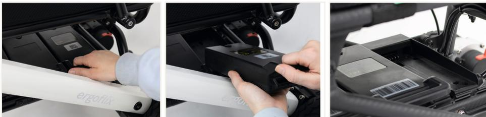
Abbildung 2: Entnehmen der Akkus mithilfe des seitlichen Griffs, um sie außerhalb des elektrischen Rollstuhls zu laden.
