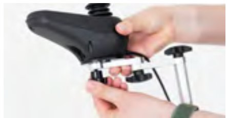
Figure 6 : Serrage du module de commande
