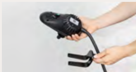
Figure 9 : Dévissage du support sur le FlixOne
