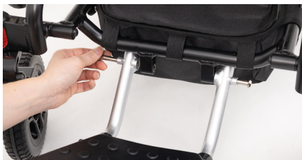
Figure 5 : Mise en place des vis écrous
