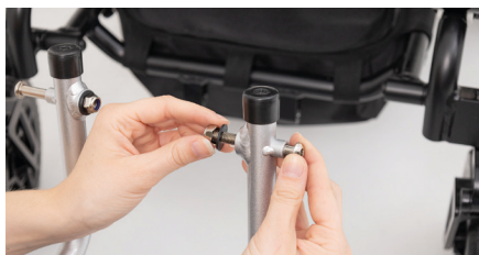
Figure 4 : Démontage de l'ensemble de vis ecrou
