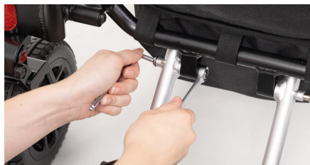
Figure 6 : Serrage de la vis écrou
