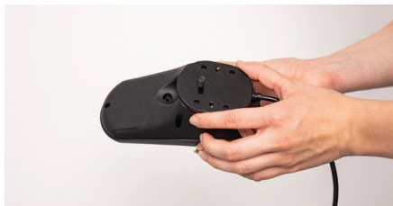
Figure 11: Mise en place de la plaque d'adaptation sous le module de commande
