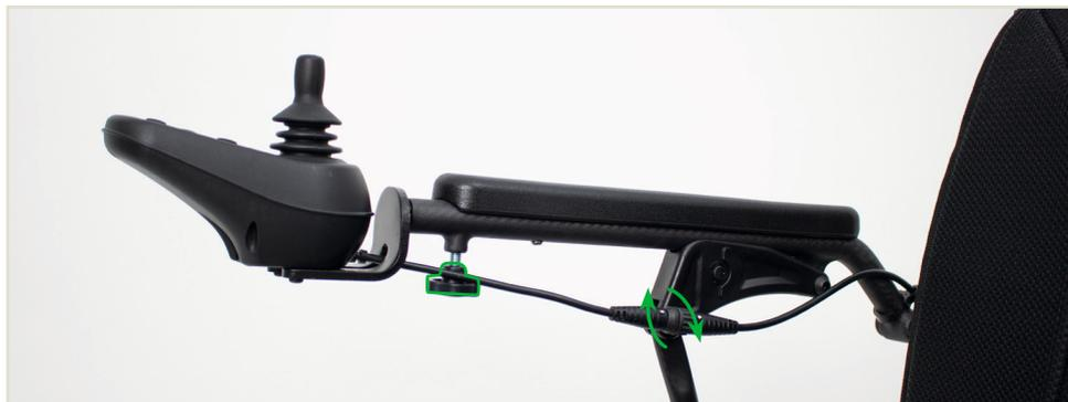
Abbildung 5: Das Bedienmodul fixieren und verbinden.
