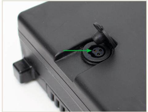
Abbildung 6: Die Anschlüsse für das Ladegerät
