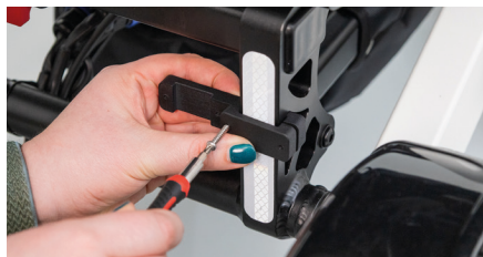
Figure 3 : Serrage de la première vis
