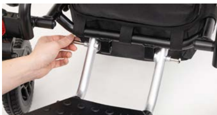
Figure 5 : Mise en place des vis écrous
