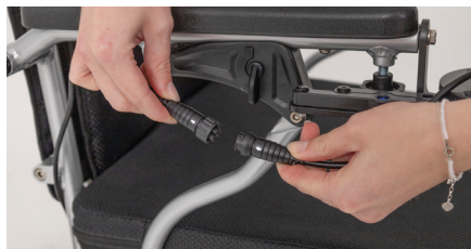
Figure 12: Connexion du câble
