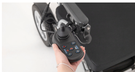
Figure 14: Pivotement du module de commande
