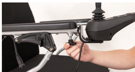
Figure 2: Desserrage la vis de blocage
