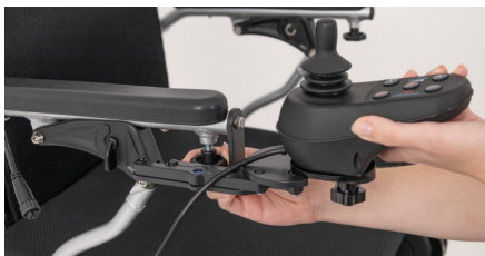
Figure 11: Mise en place du module de commande
