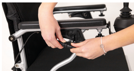
Figure 1: Séparation du câble
