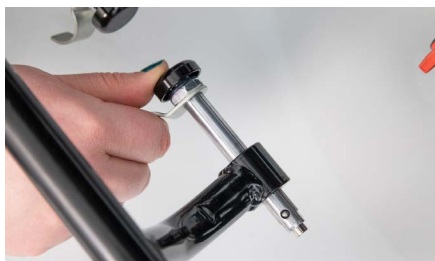
Figure 1 : Bouton-poussoir sur la goupille
