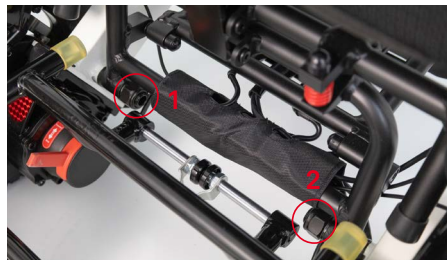
Abbildung 4: Anlegen des Anhängers
