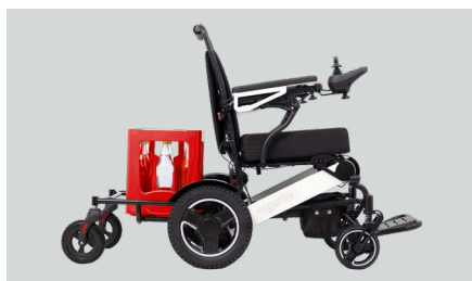
Abbildung 8: Fertig montierter Rollstuhl-Anhänger mit Getränkekiste
