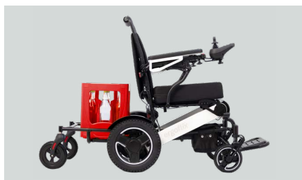
Figure 8 : Remorque pour fauteuil roulant entièrement montée avec une caisse de boissons
