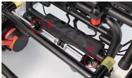
Abbildung 5: Position der Rohröffnungen
