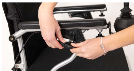
Figure 1: Séparation du câble
