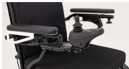
Abbildung 14: Fertig montierter Schwenkarm
