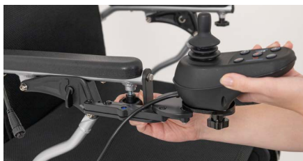
Figure 11: Mise en place du module de commande
