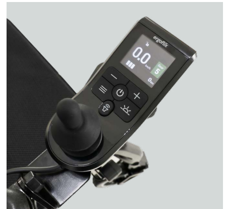
Lichtsteuerung per Bedienmodul
