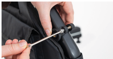
Figure 6 : Serrage des vis
