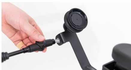
Figure 10 : Montage du rétroviseur sur le cadre métallique
