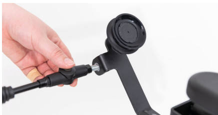
Abbildung 10: Rückspiegel am Metallgestell montieren
