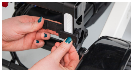
Abb. 2: Ansetzen der kürzeren, C-förmigen Klemme
