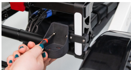
Figure 5 : Fixation du support avec les vis
