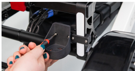
Abb. 5: Anschrauben des Köchers
