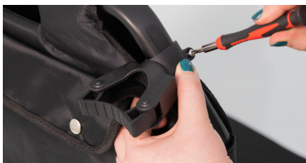
Figure 10 : Serrage du support de serrage
