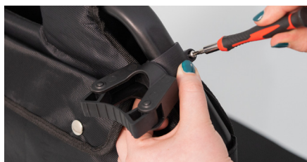
Abb. 10: Festschrauben der Klemmhalterung
