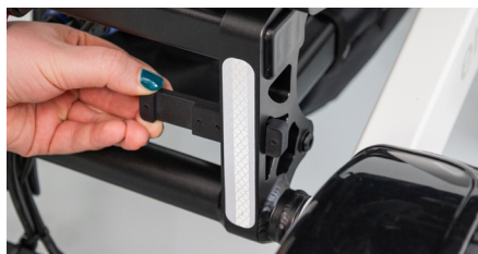
Abb. 1: Anbringung am unteren Rahmengestell
