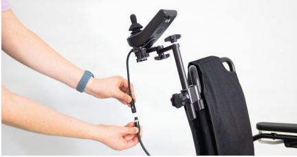
Figure 15 : Raccordement des connecteurs
