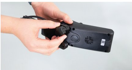
Figure 8 : Desserrage de l'écrou étoile
