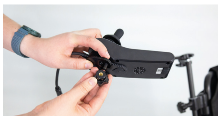
Figure 12 : Serrage de l'écrou étoile
