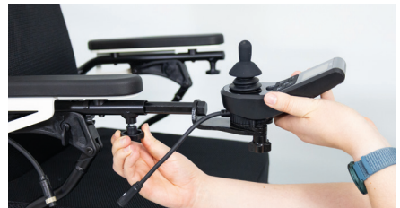
Figure 7 : Retrait du module de commande
