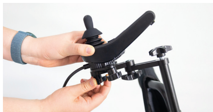
Figure 14 : Fixation du module de commande
