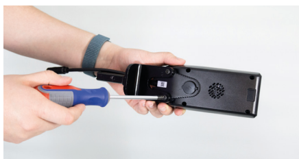
Figure 7 : dévissage de l'ancien support
