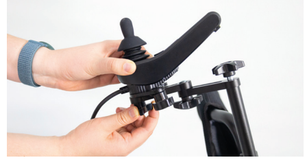
Figure 10 : Fixation du module de commande
