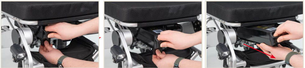
Abb. 13: Den Akku wechseln
