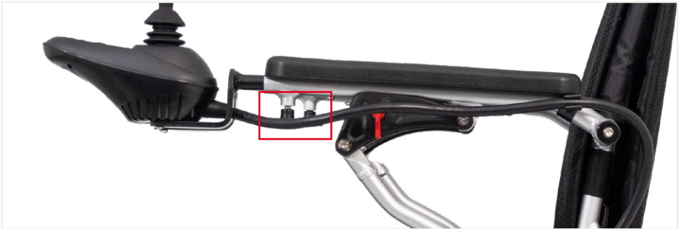
Abb. 8: Das Bedienmodul fixieren und verbinden
