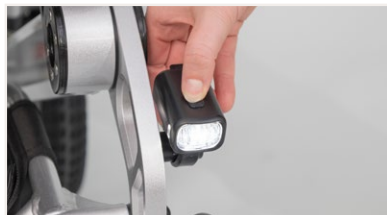
Abb. 10: Druckknopf am Vorderlicht
