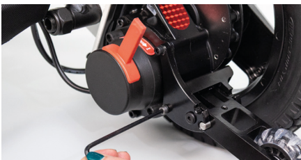
Abbildung 7: Untere Schraube anziehen
