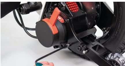
Figure 7 : Serrage de la vis inférieure
