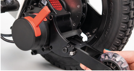
Figure 3 : Positionnement de la roulette anti-bascule
