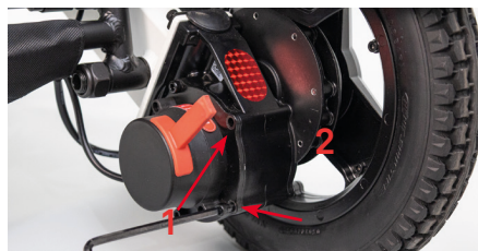
Figure 2 : Desserrage des vis – Variante B
