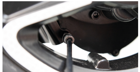
Figure 6 : Serrage de la vis extérieure
