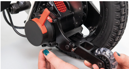
Figure 5 : Insertion de la vis inférieure
