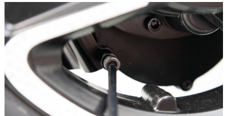
Abbildung 6: Äußere Schraube festdrehen
