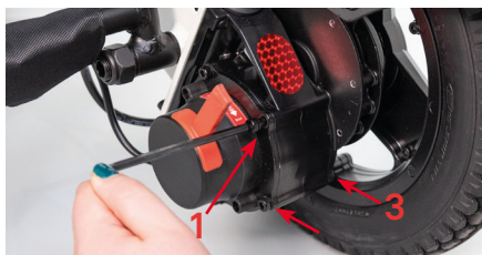
Figure 1 : Desserrage des vis – Variante A
