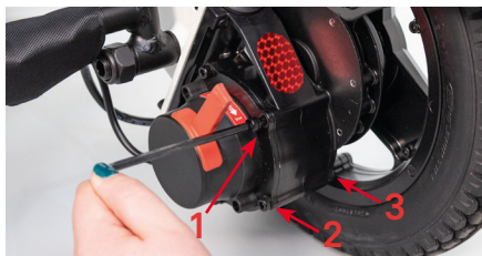
Abbildung 1: Schrauben lösen ( Variante A )
