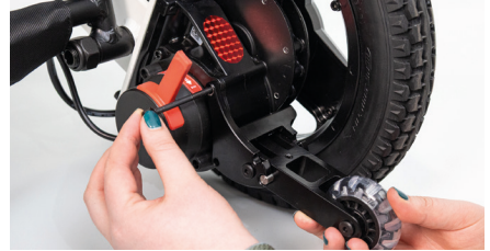
Abbildung 4: Obere Schraube einsetzen
