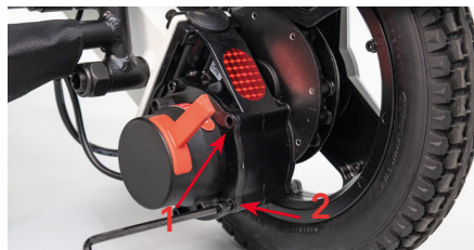
Abbildung 2: Schrauben lösen ( Variante B )
