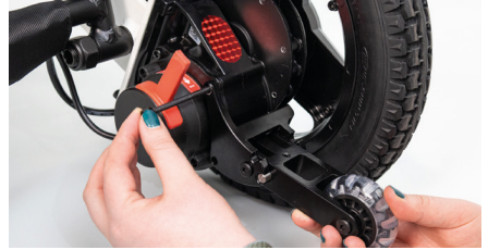
Figure 4 : Insertion de la vis supérieure
