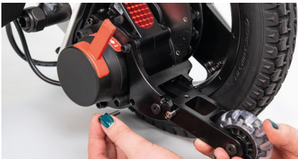
Abbildung 5: Untere Schraube einsetzen
