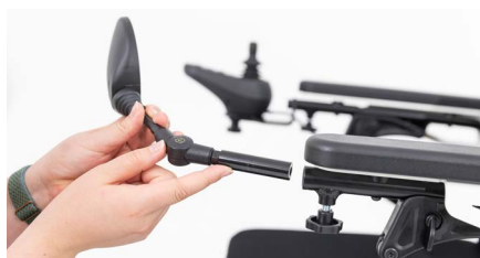
Abbildung 3: Rückspiegel in die Aufnahmeöffnung der Armlehne einführen
