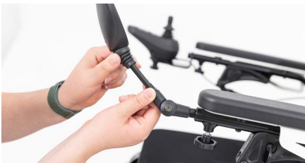
Abbildung 6: Mutter lösen, um individuelle Positionierung vorzunehmen
