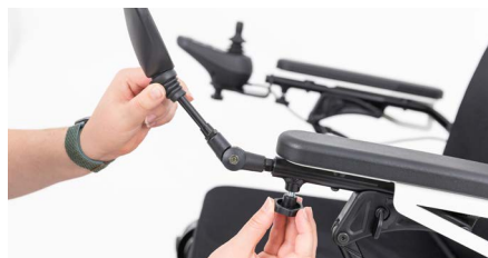
Figure 4 : Fixage de la vis de blocage
