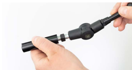
Abbildung 1: Rohradapter auf das Gewinde des Rückspiegels schrauben
