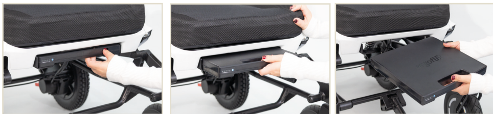
Abbildung 2: Den Akku entnehmen: Drücke auf den Druckknopf und ziehe gleichzeitig den Akku aus der Fassung.
