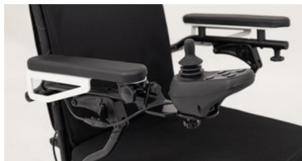
Abb. 10: Fertig montierte Höhenverstellung
