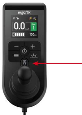
Abb. 16: Taste „Hupe“ auf dem Bedienmodul
