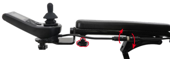
Abb. 8: Das Bedienmodul fixieren und verbinden
