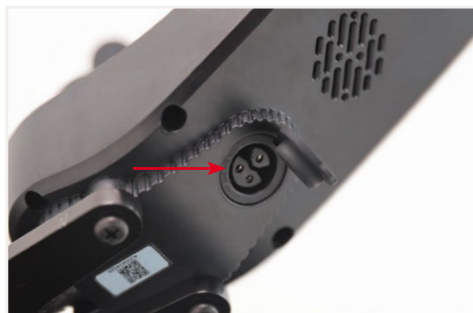
Abb. 13: Die Anschlüsse für das Ladegerät
