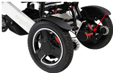
Abb. 18: Position der Feststellbremsen
