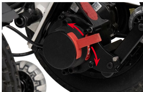
Abb. 19: Aktivieren oder Deaktivieren der Feststellbremsen
