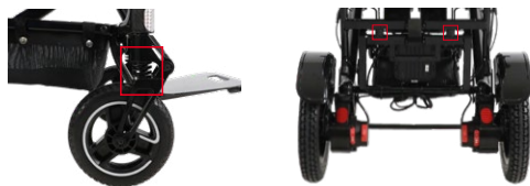
Abb. 5: Die Federungen an den Vorderradgabeln und am Sitz des ergoflix
