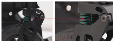
Abb. 5: Federungen an der Vorderradgabel
