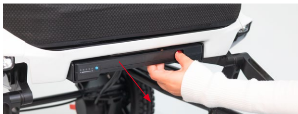
Abb. 11: Den Akku wechseln
