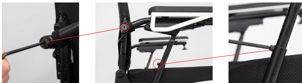
Abb. 15: Die Schraubpunkte am Armlehnenrohr und Rückenlehnenrahmen
