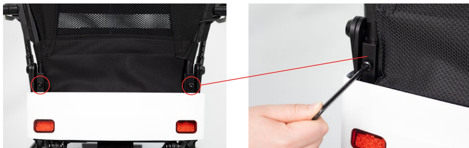
Abb. 14: Die Schraubpunkte an den Rückenlehnenrohren
