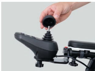
Abb. 4: Neuen Aufsatz auf den Metallstift setzen
