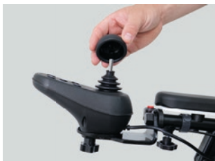
Fig. 4 : Placement du nouvel embout sur la goupille métallique
