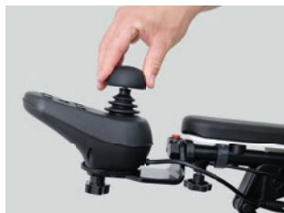
Fig. 5 : Placement du nouvel embout sur la goupille métallique
