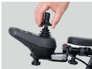
Fig. 3 : Retrait de l'embout standard du joystick
