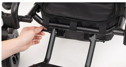
Fig. 5 : Mise en place des éléments de fixation
